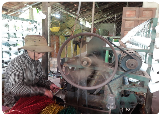
Hình 4.6. Dệt chiếu (sử dụng máy dệt)
